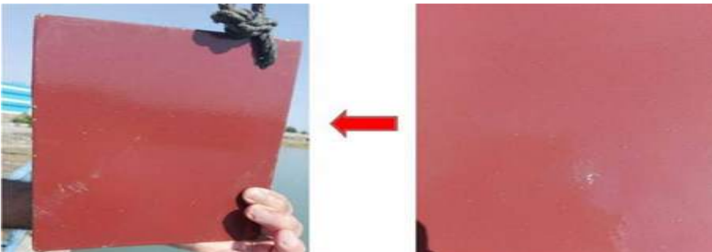
وضعیت ورق نمونه فلزی با پوشش پلی اوره ضد جلبک و موجودات زنده پس از گذشت یک هفته قرارگیری در آب دریا
