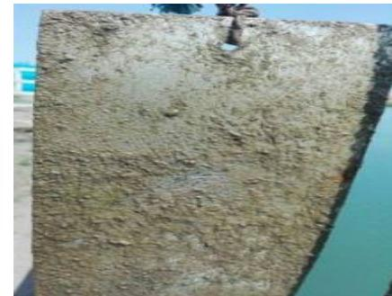
وضعیت ورق نمونه فلزی بدون پوشش دهی
